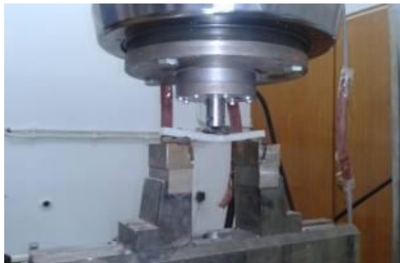
Slika 3 - Odvijanje eksperimenta na elektro-mehaničkoj kraljici INSTRON 1332
