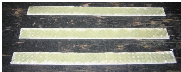
Slika 1 - Izgled isečenih uzoraka korišćenih u ispitivanjima na zatezanje (levo-orijentacija vlakana \pm 45^\circ , desno- orijentacija vlakana 0/90^\circ )
