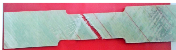
Slika 4 - Izgled prelomljenih uzoraka (Z-SE-1 ±45°)
