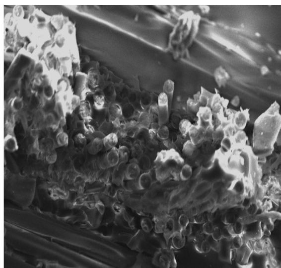
Slika 7 - Makroprslina nastale razdvajanjem veze vlakno-matrica: a) orijentacija vlakana 0/90°, b) orijentacija vlakana ±45°)
