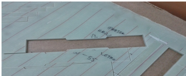
Slika 1 - Izgled isečenih uzoraka korišćenih u ispitivanjima na zatezanje (levo-orijentacija vlakana \pm 45^\circ , desno- orijentacija vlakana 0/90^\circ )
