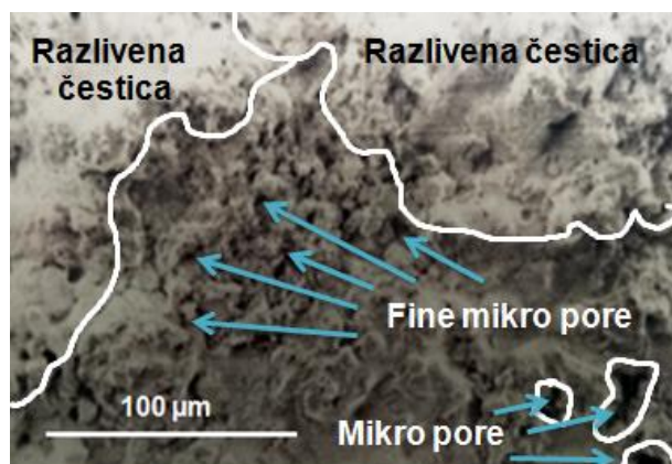
Slika 7. (SEM) Morfologija površine \text{Al}_2\text{O}_3 28tež.%MgO prevlake
