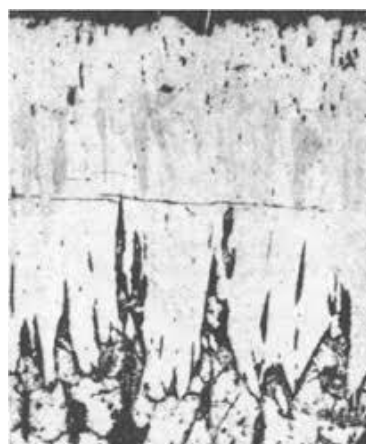
Slika 4. Pukotina paralelna sa površinom na FeB/Fe 2 B međusloju. Pukotina prve vrste prema Rile[16]
