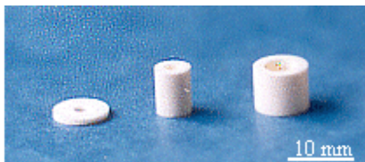
Slika 4. Delovi satnog mehanizma stonog sata. Dimenzije delova posmatrano sa leva na desno: spoljni prečnici 8,1; 5,22 i 8 mm, visine 1; 7,13 i 6,65 mm i prečnici rupa u sredini 2,55; 2,55 i 5,24 mm
