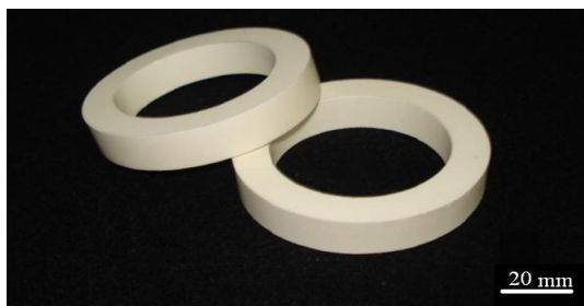
Slika 3. Keramički prstenovi za zaptivne setove pumpi za transport fluida spoljnih prečnika 63 mm i unutrašnjih prečnika 51 mm
