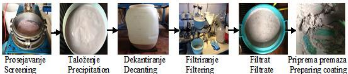
Slika 7. Priprema suspenzije vatrostalnog premaza na bazi pirofilita
