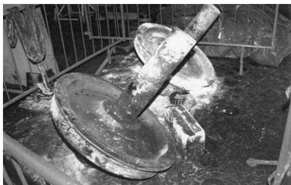
Slika 6. Prelomljena osovina iz teretnog vagona koji je učestvovao u incidentu u Rickerscote-u [25]
