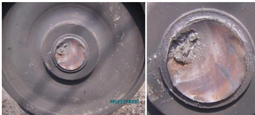
Slika 4. Polomljena osovina koja je izazvala nesreću u stanici Viareggio, Italija, (levo); uvećana površina preloma, (desno) [1]
