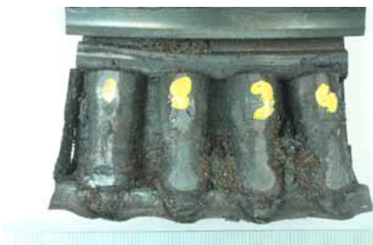
Slika 11. Pogled izbliza na plastično deformisane valjke ležaja [30]
