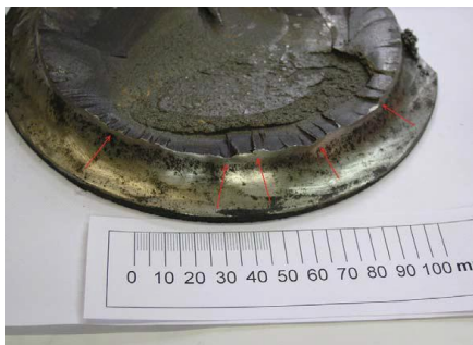
Slika 9. Detalj prelaznog radijusa na vagonskoj osovini sa višestrukim korozionim jamicama, vidljivim nakon uklanjanja rđe brušenjem [26]
