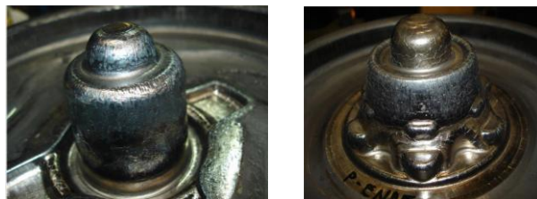
Slika 10. Izgled dva zatvorena kalupa za kovanje nakon oko 10000 ciklusa [89]
